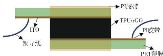
图1 所制备的传感器结构示意图
